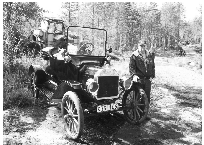
Eskil Andersson, Gransjön Lyckan i Svanskog med T-Ford från 1915. Tvåsitsig, fyrcylindrig sidventil 2,8 liters motor som ger 22 hk. Modellen kallades förr "MässingForden" p.g.a. utseendet i fronten. Luftgummidäck utan mönster. Mönster på gummidäck kom något år senare. De två främre lamporna är karbidlampor där karbidverket placerats på vänster fotsteg. De två lamporna vid vindrutan är fotogenlampor.
