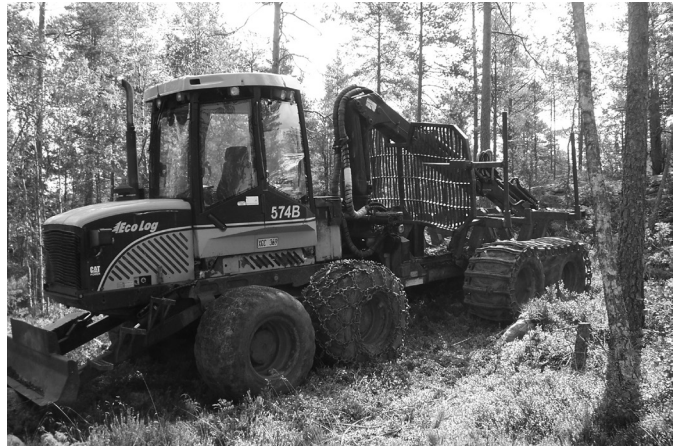
Kjell-Ingvar Svenssons slutavverkningsskotare Eco Log 574B från 2005. Väger 14 ton och lastar lika mycket.
